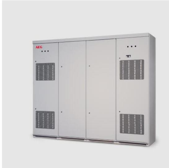
Интеллектуальная модульная система питания 48 В постоянного тока, специально разработанная для телекоммуникационных приложений, поддерживаемых высоконагруженными системами, и приложений передачи данных. В двух шкафах можно параллельно установить до 120 выпрямителей. Контроль над системой осуществляется модулем АСМi1000HD-1U, который контролирует работу всех выпрямителей и их параметры.
