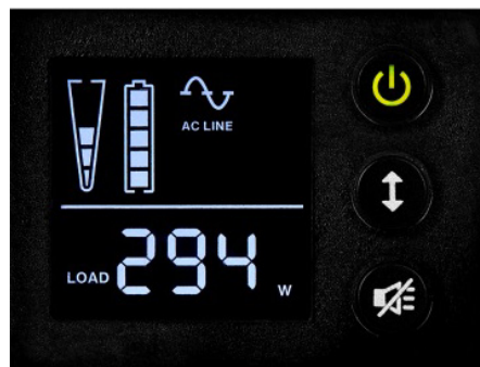
ЖК-дисплей с блоком управления в нормальном режиме работы
